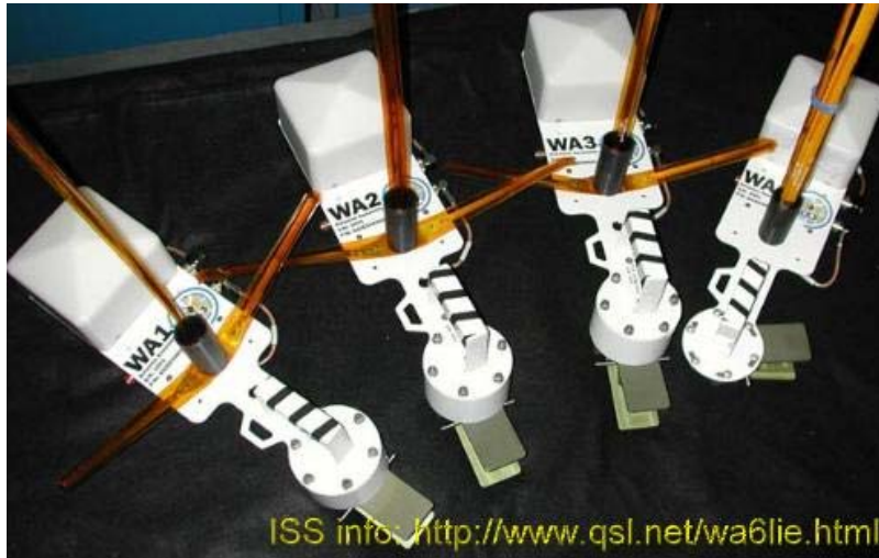
هوائيات محطة الهواة على المحطة الفضائية العالمية
